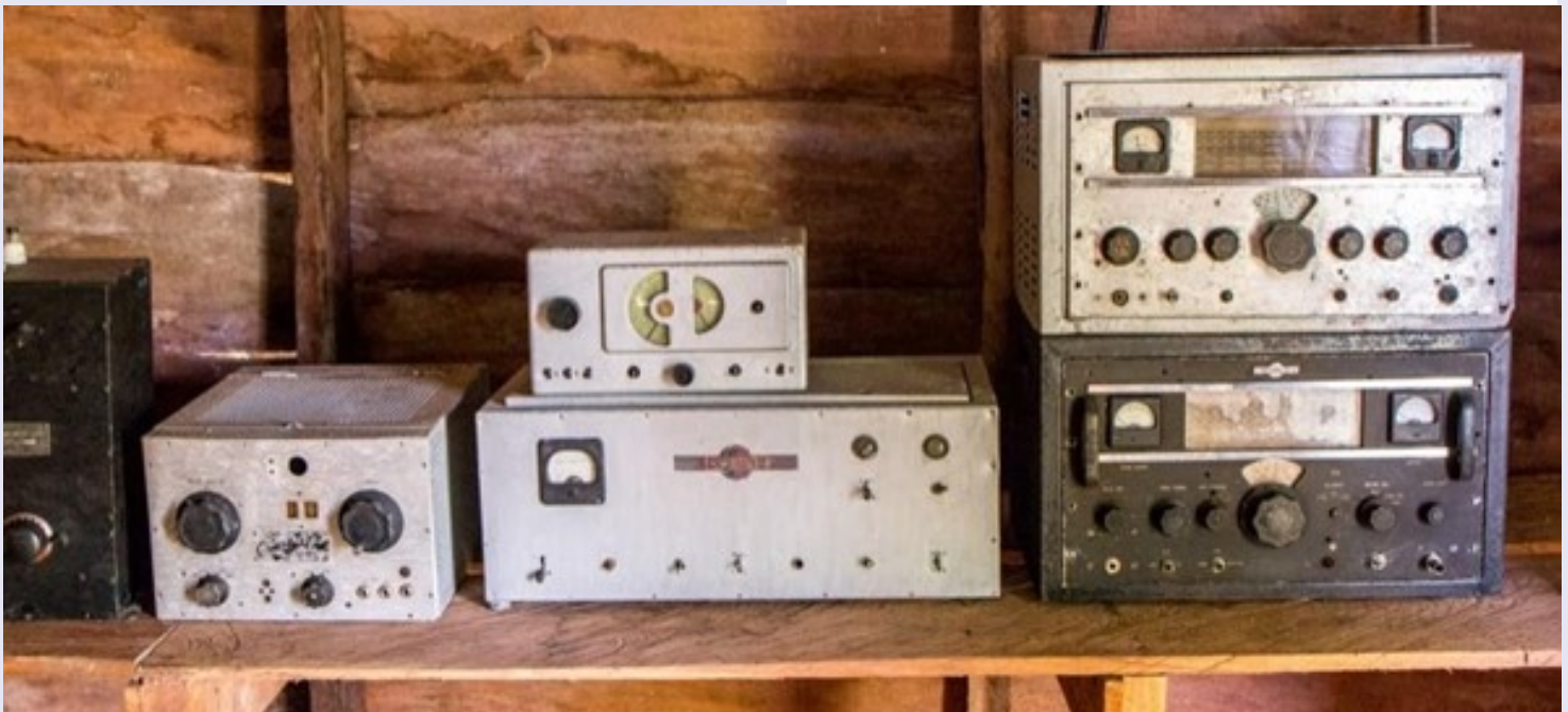
Reconstitution sommaire de la station de Radio Rebelde dans la « hutte » de la Sierra Maestra. Du matériel Collins dont deux émetteurs 32-V-2, (Source : http://breathewithus.com ).
